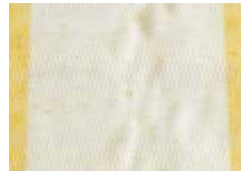
Ondulazioni al centro del telo Undulations in the middle of the cloth
